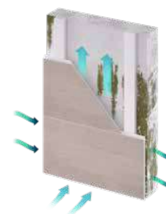
Ancoraggio con distanziale su parete con forte risalita di umidità Anchorage with spacer on wall with strong humidity return
